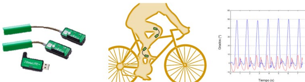
Abbildung 14 - Beispiel für ein kommerzielles drahtloses Elektrogoniometersystem (Biomec®), das zur Messung des Kniewinkels (blau) und des Knöchelwinkels (rot) beim Radfahren verwendet wird.
