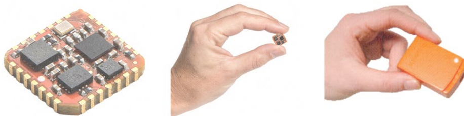
Abbildung 10 - Bild der Sensoren, aus denen eine IMU besteht, ihre Größe und dann kommerziell gekapselt, entnommen aus Xsens ®
