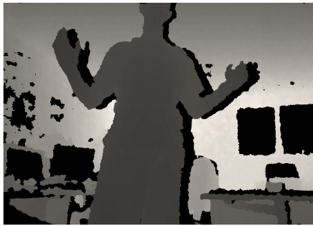
Abbildung 7. Bild der Tiefenkarte unter Verwendung des OpenNI-Tools, aus Dyce et al. [9].
