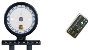
Abbildung 15 - Baseline® Acu-Angle Blasenneigungsmesser (links) und DTS 2d Noraxon® elektronischer Neigungsmesser.
