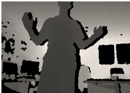
Figura 7. Imagen del mapa de profundidad usando la herramienta OpenNI, de Dyce et al. [9].
