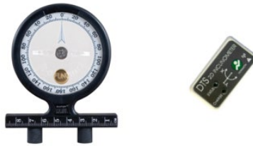
Figura 15 – Inclinómetro de burbuja Baseline® Acu-Angle (izquierda) e inclinómetro electrónico DTS 2d Noraxon®.
