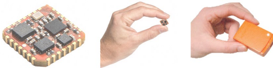
Figur 10 – Imagen de los sensores que componen una IMU, su tamaño, y luego encapsulados comercialmente, extraída de Xsens ®
