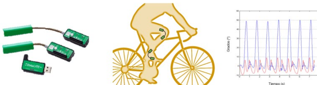
Figura 14 – Ejemplo de un sistema de electrogoniómetro inalámbrico comercial (Biomec®) utilizado para medir el ángulo de la rodilla (azul) y el tobillo (rojo) en el ciclismo.
