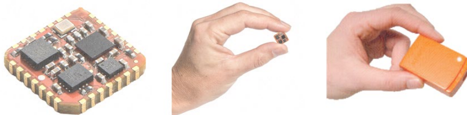
Rysunek 10 - Obraz czujników wchodzących w skład jednostki IMU, ich rozmiar, a następnie umieszczonych w obudowie w celach komercyjnych, z Xsens ©
