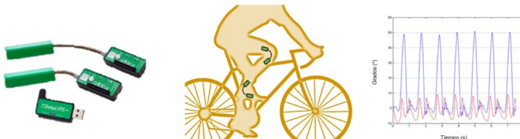
Rysunek 14 - Przykład komercyjnego bezprzewodowego systemu elektrogoniometrycznego (Biomec®) używanego do pomiaru kąta kolana (kolor niebieski) i stawu skokowego (kolor czerwony) podczas jazdy na rowerze.
