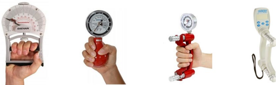
Bild 14 - Beispiele für Dynamometer (von links nach rechts): mechanisch gefedert (Saehan Smedley Handdynamometer), pneumatisch (Saehan Handgriffdynamometer), hydraulisch, (Baseline® Hydraulische Handdynamometer) und digital hydraulisch (Jamar Plus+ Digitales Handdynamometer).
