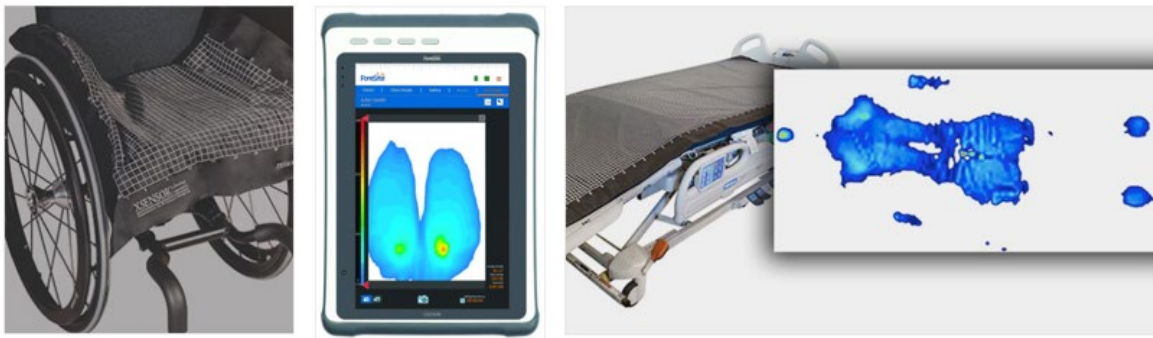
Figura 12 – Ejemplos de colchonetas de presión Xsensor © para evaluar la superficie de sillas de ruedas y camas, imágenes extraídas de https://xsensor.com/applications/wheelchair-seating/ y https://xsensor.com/applications/mattress-design-rd/
