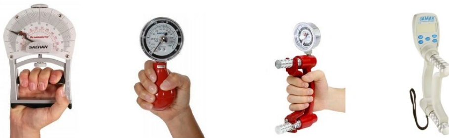
Figurea14 –Ejemplos de dinamómetros (de izquierda a derecha): resorte mecánico (dinamómetro manual Saehan Smedley), neumático (dinamómetro manual Saehan), hidráulico (dinamómetro manual hidráulico Baseline®) e hidráulico digital (dinamómetro manual digital Jamar Plus +).
