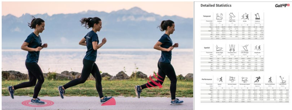
Figura 9 – Sistema de sensor de inercia GaitUp® para analizar la marcha al correr. El sensor está ubicado en la zona del antepié del corredor. Extraído de https://gaitup.com/running-analysis/physirun-lab/
