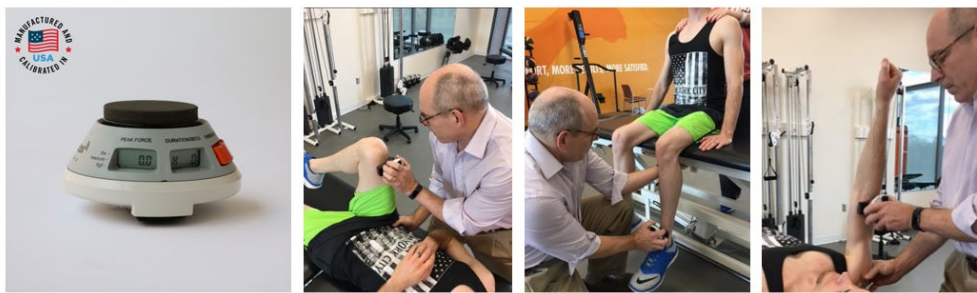
Figura 15 – Ejemplo de un dinamómetro digital manual: microFET@2 de Hoggan Scientific ©, imágenes extraídas de https://hogganscientific.com/product/microfet2-muscle-tester-digital-handheld-dynamometer/
