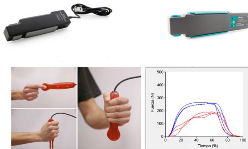
Figura 16 – Ejemplo de dinamómetros electrónicos basados en galgas extensométricas para medir la fuerza de agarre y pellizco, así como la fatiga muscular: (arriba) dinamómetros con cable e inalámbricos de Vernier ©, imágenes extraídas de https://www.vernier.com/products/sensors/hand- Dinamómetros /, (abajo) ejemplo del dinamómetro NedVEP / IBV asociado con el software NedMano / IBV, que proporciona representaciones de las repeticiones de fuerza máxima de agarre de la mano derecha (rojo) y la mano izquierda (azul).
