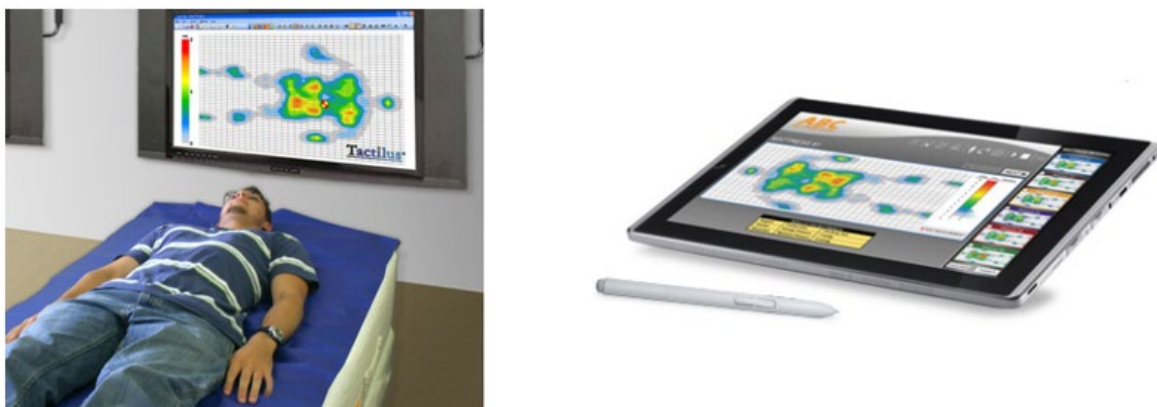
Figura 26 – Ejemplo de un análisis de la distribución de presión entre persona - colchón utilizando el sistema Tactilus Bodyfitter® y mapa de presión (derecha), imágenes extraídas de https://www.sensorprod.com/dynamic/mattress.php
