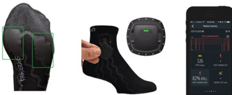
Figura 23 – Sistema de sensor de presión integrado en la aplicación Sensoria © Smart Sock, Sensoria © Core y Sensoria® Run, imágenes extraídas de https://www.sensoriafitness.com/
