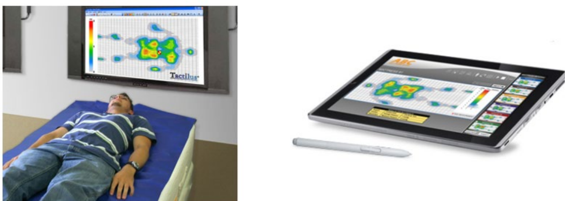
Rysunek 26 - Przykład analizy rozkładu nacisku między osobą a materacem przy użyciu systemu Tactilus Bodyfitter® i mapy nacisku (po prawej), obrazy zaczerpnięte z https://www.sensorprod.com/dynamic/mattress.php
