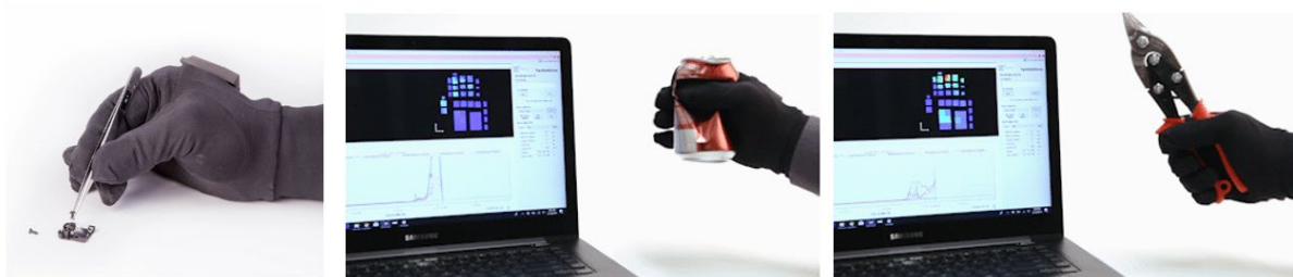
Rysunek 13 - Przykład systemu analizy nacisku w rękawicy Tactile Glove - Pomiar nacisku na dłoni przez PPS©, zdjęcia zaczerpnięte z https://pressureprofile.com/body-pressure-mapping/tactile-glove
