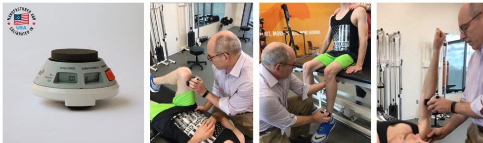
Rysunek 15 - Przykład ręcznego dynamometru cyfrowego: microFET®2 firmy Hoggan Scientific®, obrazy zaczerpnięte z https://hogganscientific.com/product/microfet2-muscle-tester-digital-handheld-dynamometer/
