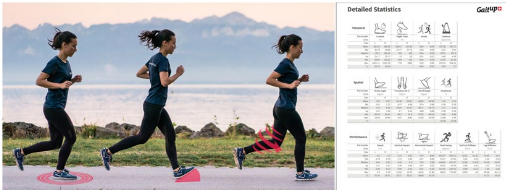
Rysunek 9 - System czujników inercyjnych GaitUp® do analizy chodu biegacza. Czujnik umieszczony jest w okolicy przodostopia biegacza. Zaczerpnięte z https://gaitup.com/running-analysis/physirun-lab/
