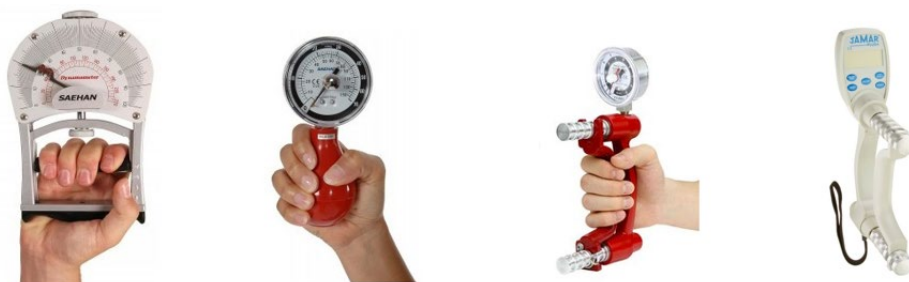
Rysunek 14 - Przykłady dynamometrów (od lewej do prawej): mechaniczny sprężynowy (Saehan Smedley Hand Dynamometer), pneumatyczny (Saehan hand grip dynamometer), hydrauliczny (Baseline® Hydraulic Hand Dynamometers) i cyfrowy hydrauliczny (Jamar Plus+ Digital Hand Dynamometer).
