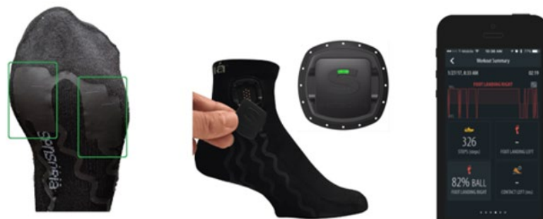
Rysunek 23 - System czujników ciśnienia wbudowany w Sensoria© Smart Sock, Sensoria© Core i aplikację Sensoria© Run, obrazy zaczerpnięte z https://www.sensoriafitness.com/
