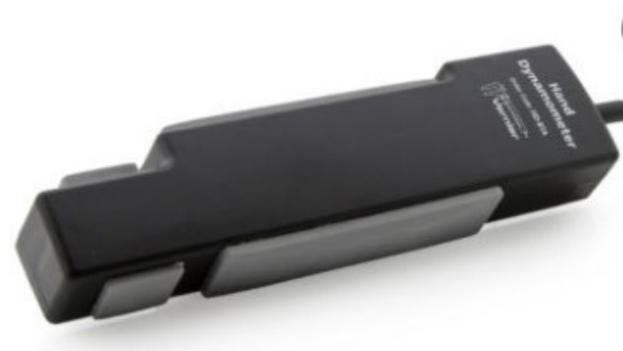
El dinamómetro de mano isométrico basado en galgas extensométricas se puede utilizar para medir la fuerza de agarre, la fuerza de pinza y para realizar estudios sobre fatiga muscular. Se puede utilizar con otros sensores (por ejemplo, el EKG) para estudiar la salud y la actividad muscular.
