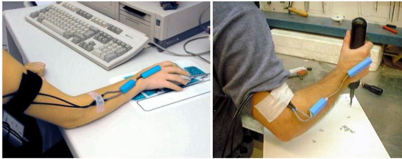
Figura 5: Registro biomecánico de la postura durante las tareas laborales con electrogoniómetros.
