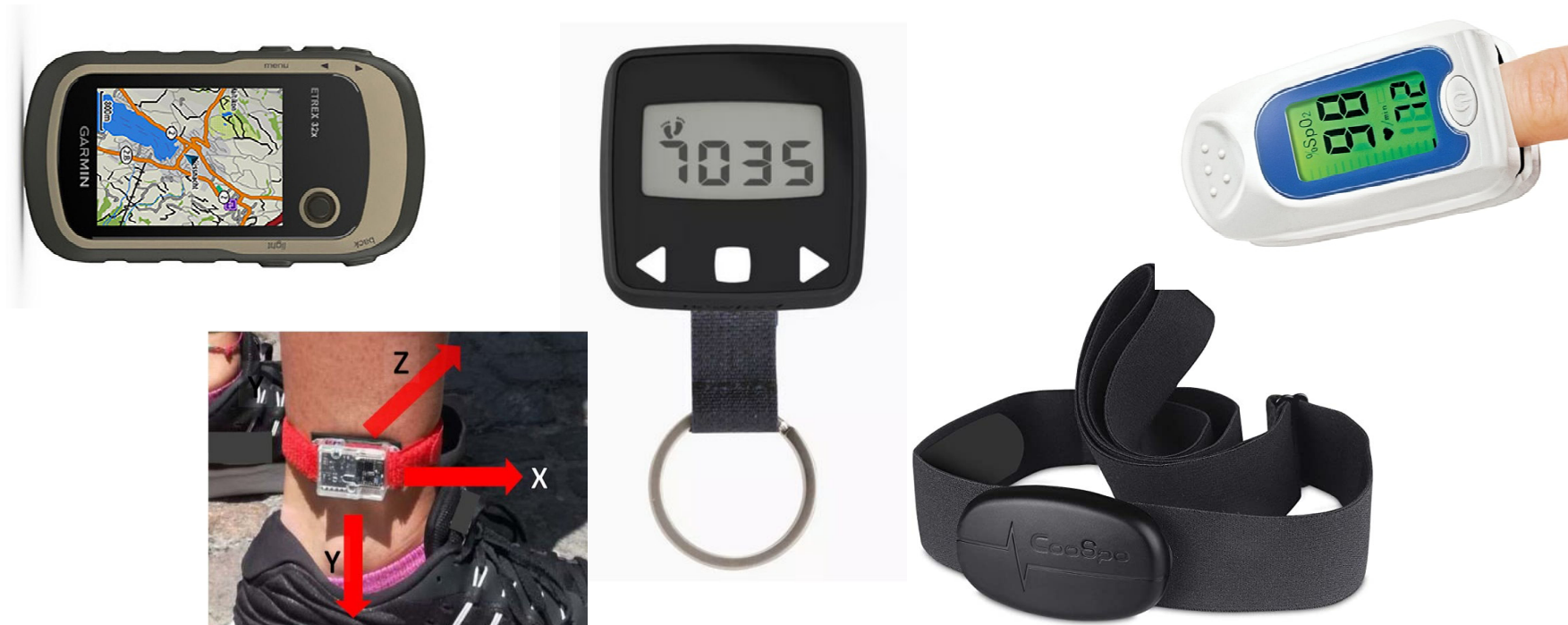
Abbildung 14. Werkzeuge für die Messung des Energieaufwands. Von links nach rechts: Globales Positionssystem, Beschleunigungsmesser, Schrittzähler, Herzfrequenzmesser und Sauerstoffverbrauchsmesser.
