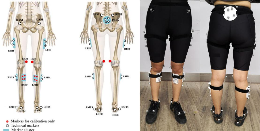
Abbildung 7 - Marker-Layout des Strathclyde-Funktionscluster-Modells (links) und ein kombiniertes Marker-Setup für das SFCM-, PiG- und HBM2-Modell (rechts).
