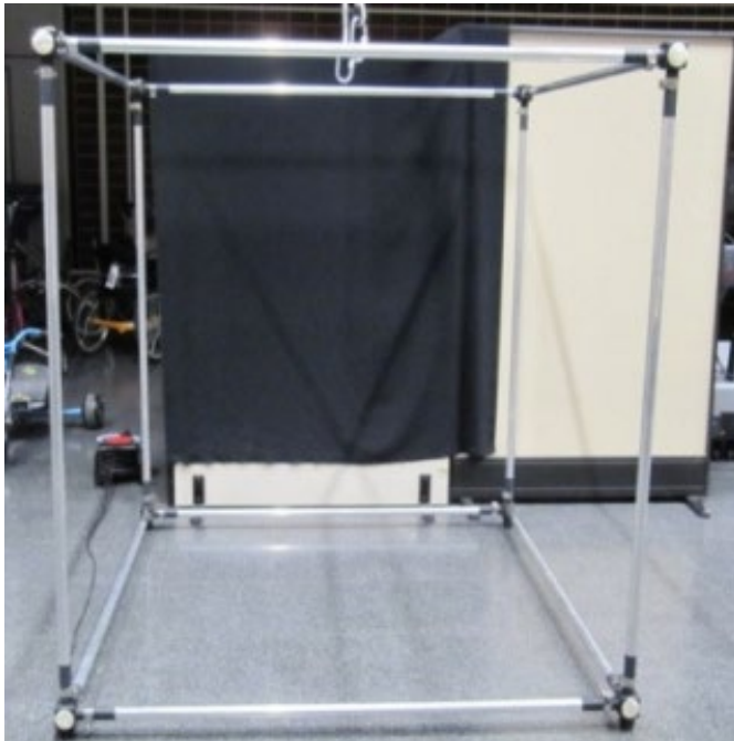
Abbildung 7. Starre kubische Struktur für die statische Raumkalibrierung in der zweidimensionalen Analyse
