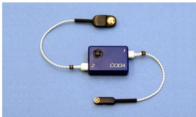
Abbildung 12: Aktive Marker (Bild aus J. Richards et al. 2018)
