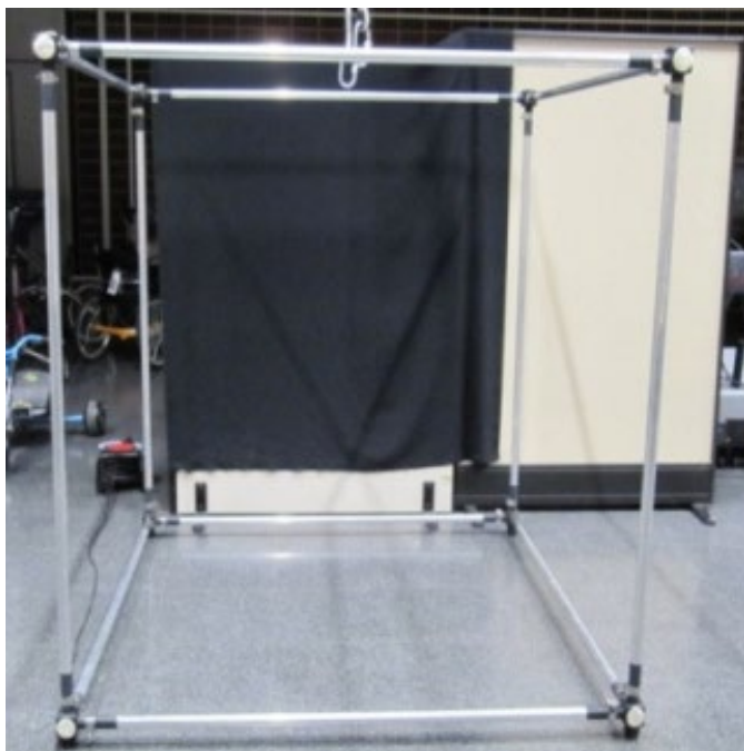
Abbildung 8. Starre kubische Struktur für die statische Raumkalibrierung in der dreidimensionalen Analyse
