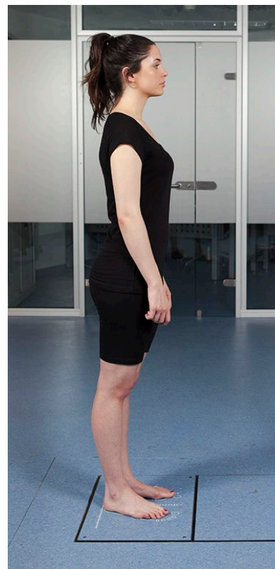
Abbildung 8. Gewichtsregistrierung auf einer dynamometrischen Plattform vor der Ganganalyse.
