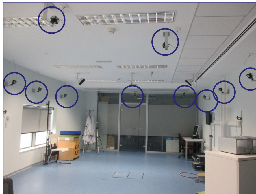
Abbildung 2. Konfiguration der Kameras für die Analyse in zwei Dimensionen gegenüber drei Dimensionen. Labor des Fachbereichs Medizin. Universität von Valencia
