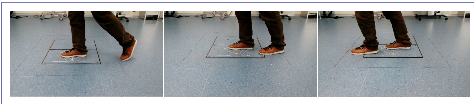
Abbildung 11. Beurteilung der Gangart mit dynamometrischer Plattform. (Links) Gültige Wiederholung. (Mitte) Ungültige Registrierung aufgrund der Störung durch den vorherigen Schritt. (Rechts) Ungültige Registrierung aufgrund der Störung des nächsten Schritts.
