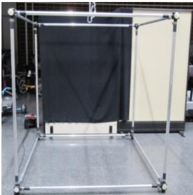
Figura 8. Estructura cúbica rígida para calibración de espacio estático en análisis tridimensional.
