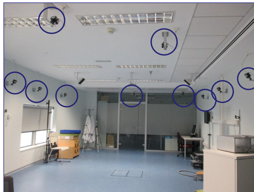
Figura 2. Configuración de cámaras para análisis en dos dimensiones versus tres dimensiones. Laboratorio del Departamento de Medicina. Universidad de Valencia
