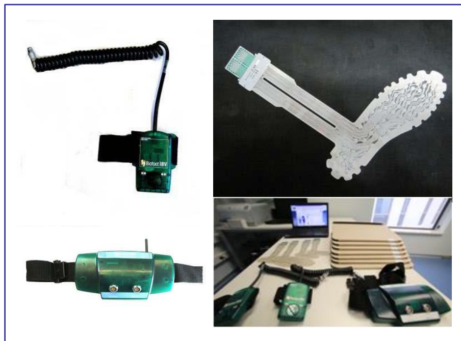
Figura 2. Elementos de un sistema de medición de la presión plantar basado en plantillas instrumentadas. Sistema de Biofoot / Institutos de Biomecánica de Valencia.
