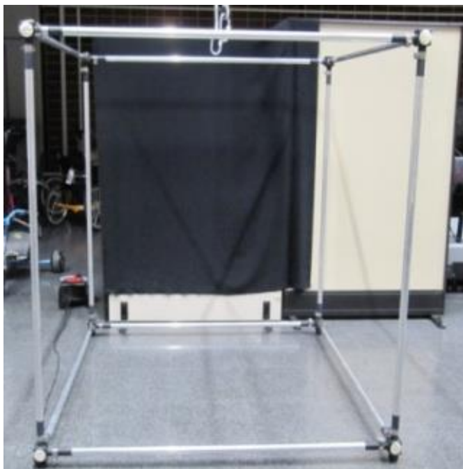
Figura 7. Estructura cúbica rígida para calibración de espacio estático en análisis bidimensional.
