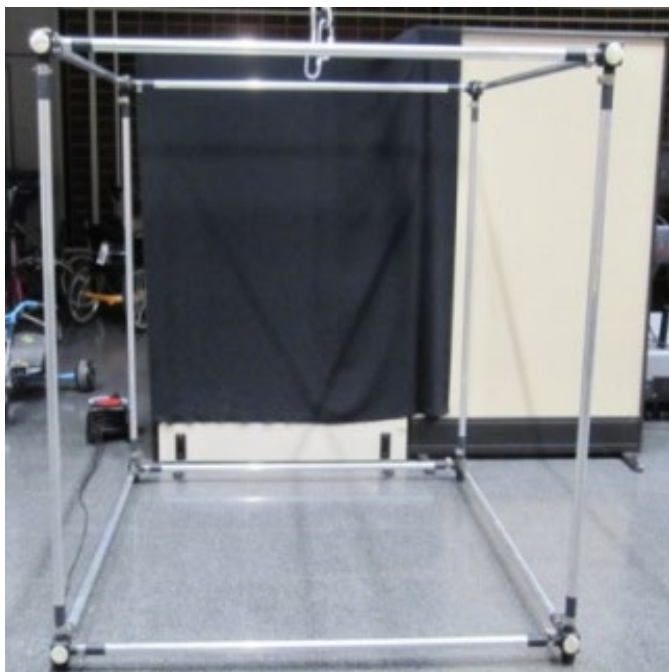
Rysunek 7. Sztywna struktura sześcienna do statycznej kalibracji przestrzeni w analizie dwuwymiarowej
