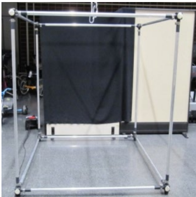
Rysunek 8. Sztywna struktura sześcienna do statycznej kalibracji przestrzeni w analizie trójwymiarowej
