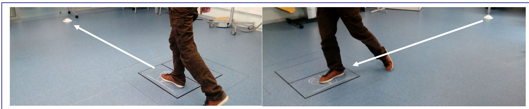
Rysunek 10. Wydzielony chodnik do oceny chodu z platformą dynamometryczną. (Po prawej) Przestrzeń umożliwiającą przyspieszenie przed wejściem na platformę. (Po lewej) Przestrzeń pozwalającą na wyhamowanie po wejściu na platformę.
