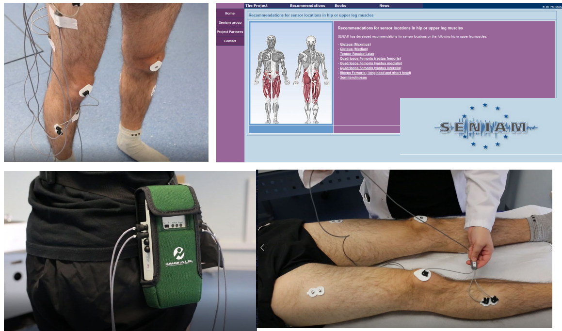
Abbildung 1 - Oberflächen-Elektromyographie-System und Instrumentierung der unteren Extremität. Zur Festlegung des Instrumentierungsprotokolls sollte der SENIAM-Leitfaden verwendet werden, der die Lage der Elektroden in den verschiedenen Körpersegmenten standardisiert. ( www.seniam.org ).
