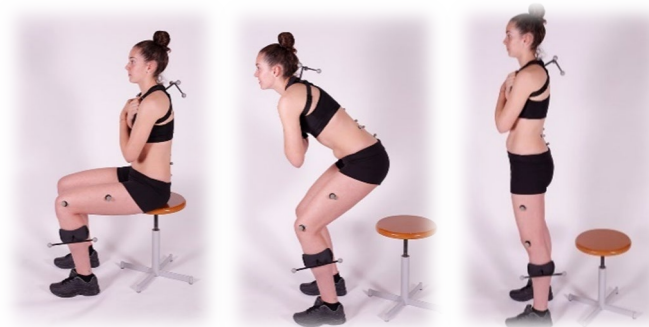
Abbildung 16: Messung der Geste des Aufstehens von einem Stuhl. Sistema NedLumbar/IBV (Quelle: Instituto de Biomecánica de Valencia).
