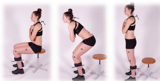
Figure 16: Mierzenie gestu wstawania z krzesła. Sistema NedLumbar/IBV (Źródło: Instituto de Biomecánica de Valencia).
