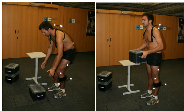
Abbildung 20. Biomechanischer und funktioneller Bewertungstest unter Verwendung eines Photogrammetriesystems und dynamometrischer Plattformen zur Bewertung der Bewegung des Bückens, Aufnehmens und Hebens eines Gewichts.
