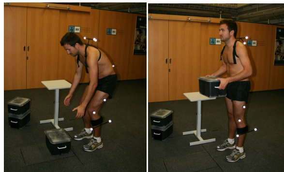
Figura 19. Prueba biomecánica de valoración funcional del gesto de flexionarse, coger y levantar un peso utilizando un sistema de fotogrametría y plataformas dinamométricas.
