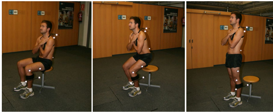
Figura 15. Prueba biomecánica de valoración funcional del gesto de levantarse de una silla utilizando un sistema de fotogrametría y plataformas dinamométricas.
