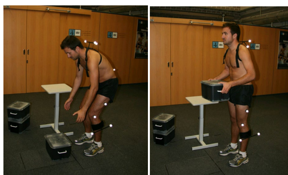
Rysunek 19. Badanie oceny biomechanicznej i funkcjonalnej z wykorzystaniem systemu fotogrametrycznego i platform dynamometrycznych do oceny ruchu schylania się, podnoszenia ciężaru i unoszenia go
